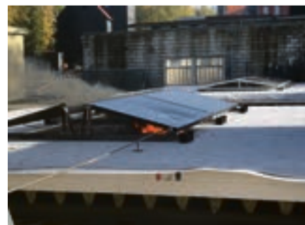
▲ Grootschalige brandtest met glas-glas zonnepanelen op EPS-dak: de brand is ontstoken onder het zonnepaneel en ongeveer op het hoogst waargenomen vermogen (na circa 10 minuten).
