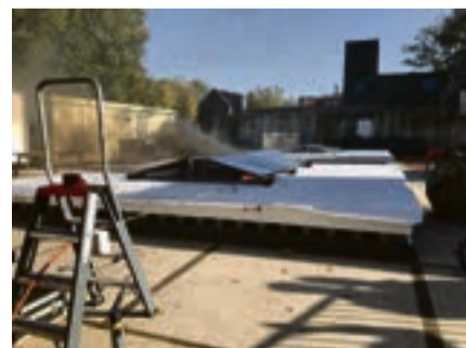
▲ Grootschalige brandtest met glas-glas zonnepanelen op EPS-dak: de laatste vlammen voordat de brand vanzelf dooft (na circa 20 minuten).
