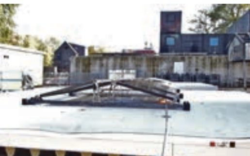
▲ Grootschalige brandtest met glas-glas zonnepanelen op EPS-dak: het moment waarop de dakbedekking gaat branden (na circa 5 minuten).
