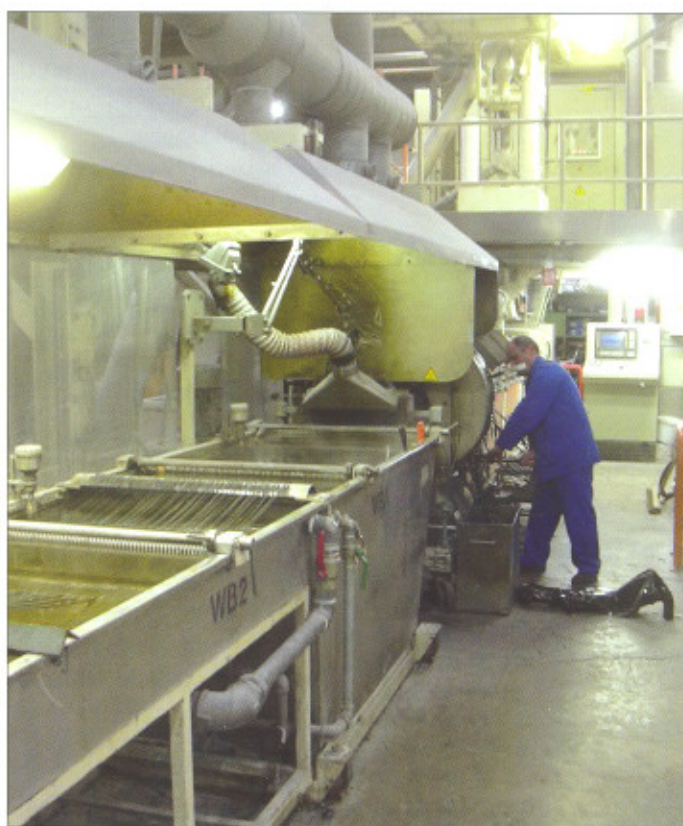
De extrusie-opstelling waarin het gedroogde slib verder wordt verwerkt.
